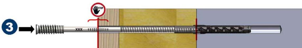
3.) Vorsichtiges Einschlagen der Schraube mit aufgesteckter Dübelhülse.
