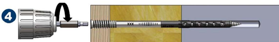
4.) Langsames Eindrehen (ca. 100 U/min) bis die Endposition (Schraubenkopf ist bündig oder
