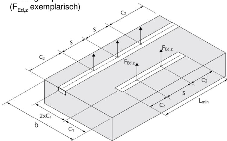
Auf der Schienenoberfläche ist eine Ausmitte der Last  $F_{Ed}$  zur Längsachse (x-Achse) in y-Richtung  $e \leq 10\text{ mm}$  zulässig.
