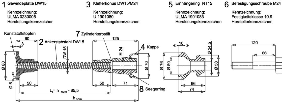
**Bild 3.2 Verankerung ULMA Klappkonsole mit ULMA Kletterkonus DW15/M24**
