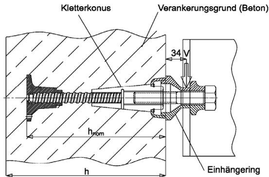
**Bild 1.2** ULMA Kletterkonus DW15/M24 mit ULMA Klappkonsole
