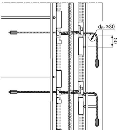
**Bild 16: Anschluss Wand – Wand,
