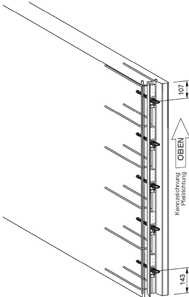
**Bild 6: Randabstände der flachen und tiefen Schiene**
