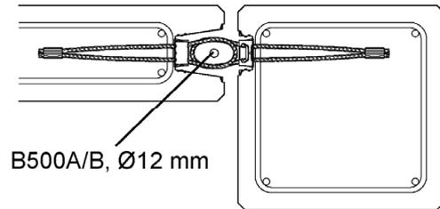
**Bild 15: Anschluss Wand - Stütze**
