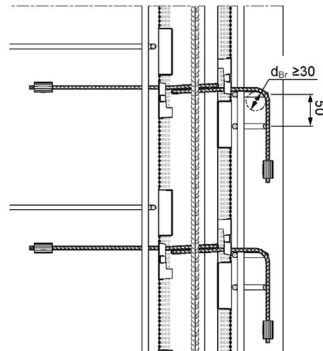
**Bild 17: Anschluss Wand – Wand, (Eckstoß),
