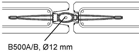
**Bild 14: Anschluss Wand – Wand,
