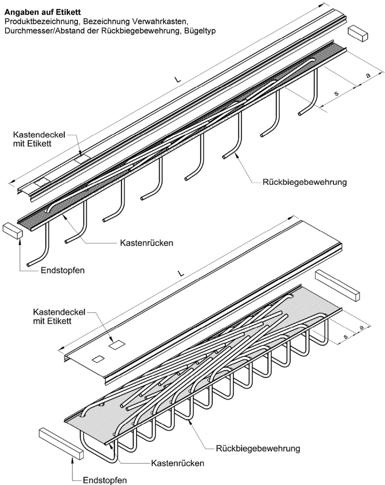
**Abbildung 2:** Aufbau Verwehrkasten, Rückbiegebewehrung einlagig/zweilagig
