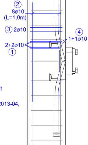
Zusatzbewehrung in Rundstützen ( $380 \leq d < 560\text{mm}$ ):
