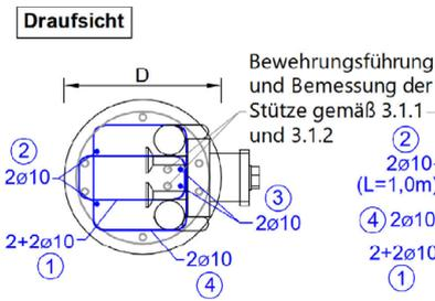
Bügel Pos. ① und ④ mit  $l_0$  - geschlossen
