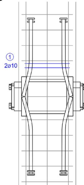
Peikko PCs Konsole zum Anschluss von Balken an Wände und Stützen
