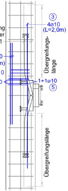
Peikko PCs Konsole zum Anschluss von Balken an Wände und Stützen
