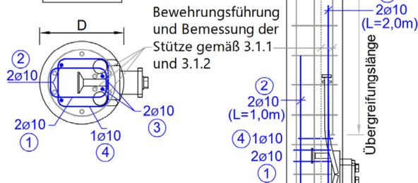
Bügel Pos. ① und ④ mit  $l_0$  - geschlossen
