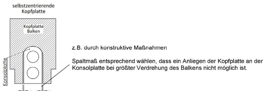
Peikko PCs Konsole zum Anschluss von Balken an Wände und Stützen
