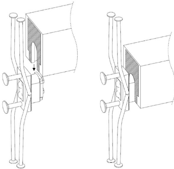
Bild 11: Anschlussträger aufsetzen
