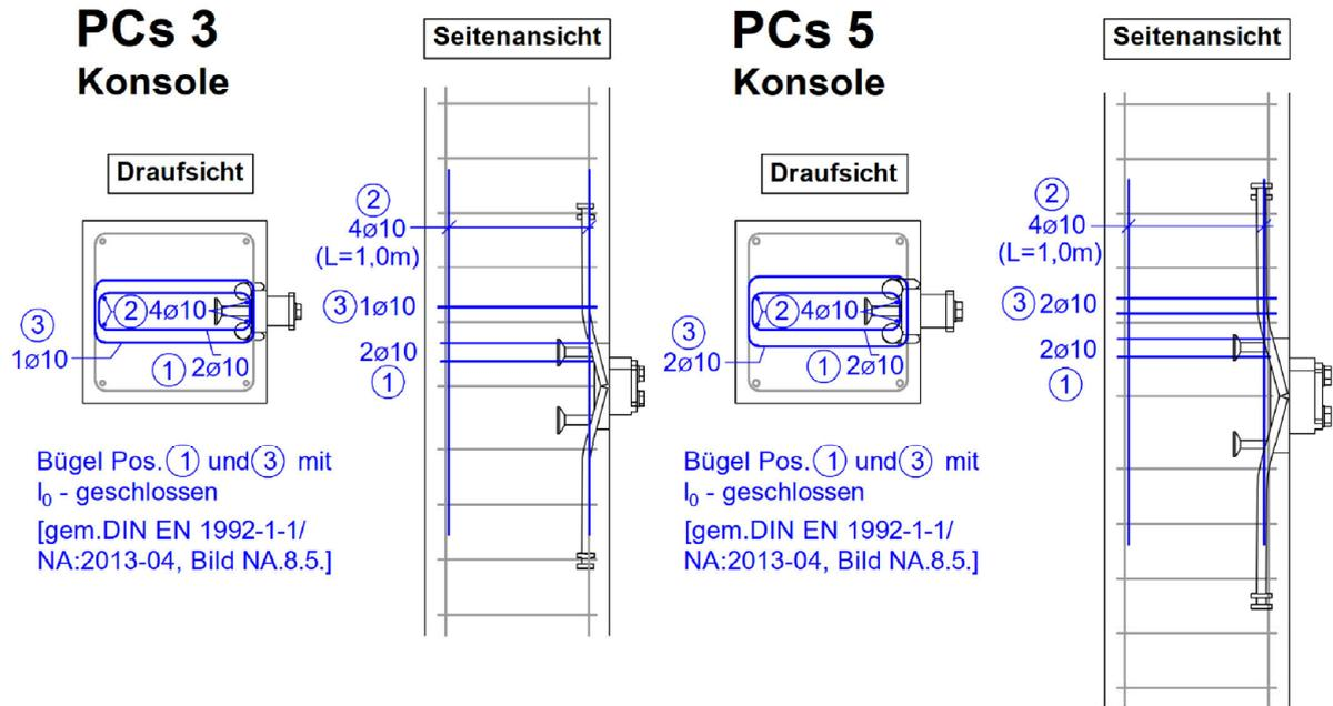
Zusatzbewehrung in Rundstützen ( $d \geq 360\text{mm}$ ):
