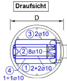
Bügel Pos. ① ③ und ④ mit  $l_0$  - geschlossen
