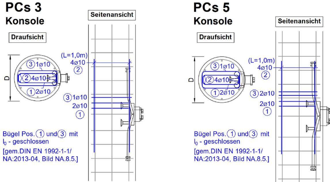
Peikko PCs Konsole zum Anschluss von Balken an Wände und Stützen
