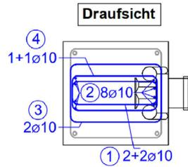
Bügel Pos. ① ③ und ④ mit  $l_0$  - geschlossen
