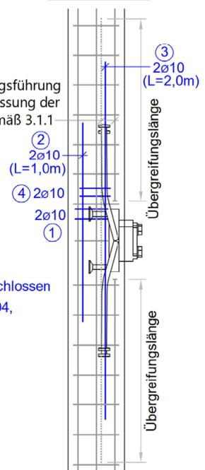
Peikko PCs Konsole zum Anschluss von Balken an Wände und Stützen
