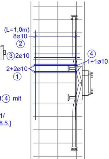
Peikko PCs Konsole zum Anschluss von Balken an Wände und Stützen
