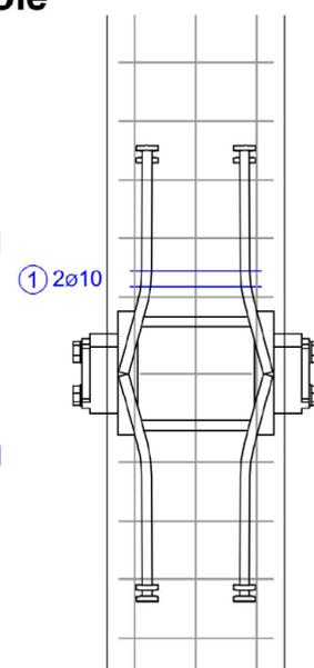
Peikko PCs Konsole zum Anschluss von Balken an Wände und Stützen
