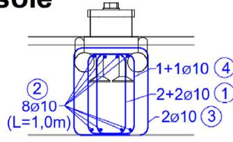
Bügel Pos. ① ③ und ④ mit  $l_0$  - geschlossen
