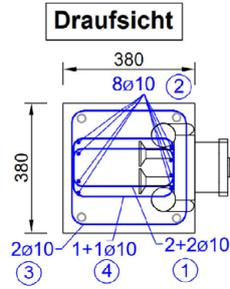
Bügel Pos. ① ③ und ④ mit  $l_0$  - geschlossen
