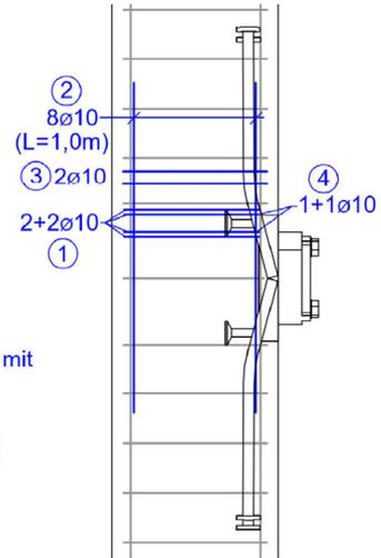
Zusatzbewehrung in Rundstützen (d  $\geq$  560mm):
