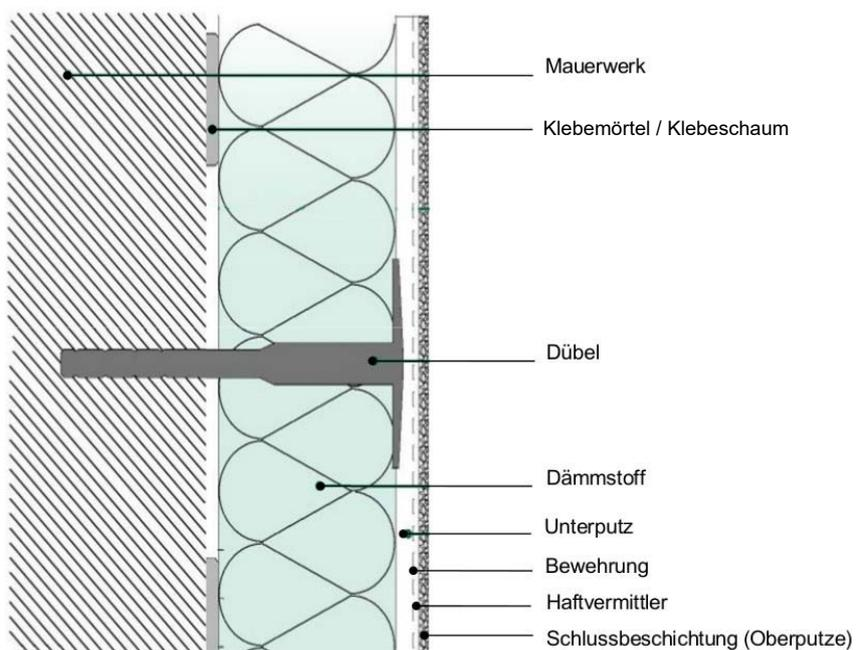
**Teilflächige Verklebung der Dämmplatten auf dem Untergrund**
