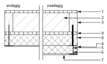
WDVS bei Anwendung auf massiven Holzuntergründen
