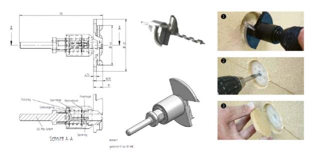
Die Dübellöcher werden mit dem INTHERMO HFD-Bohrtool gebohrt. In das Bohrtool wird der mitgelieferte Spiralbohrer für Holz eingesetzt. Es werden in einem Arbeitsgang die Ausfräsung für den Tellerdübel erstellt sowie das Loch in der Platte (1).
