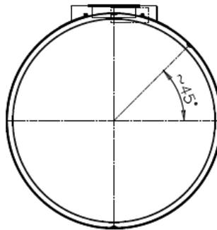
Liegende zylindrische doppelwandige Behälter aus Stahl zur unterirdischen Lagerung
