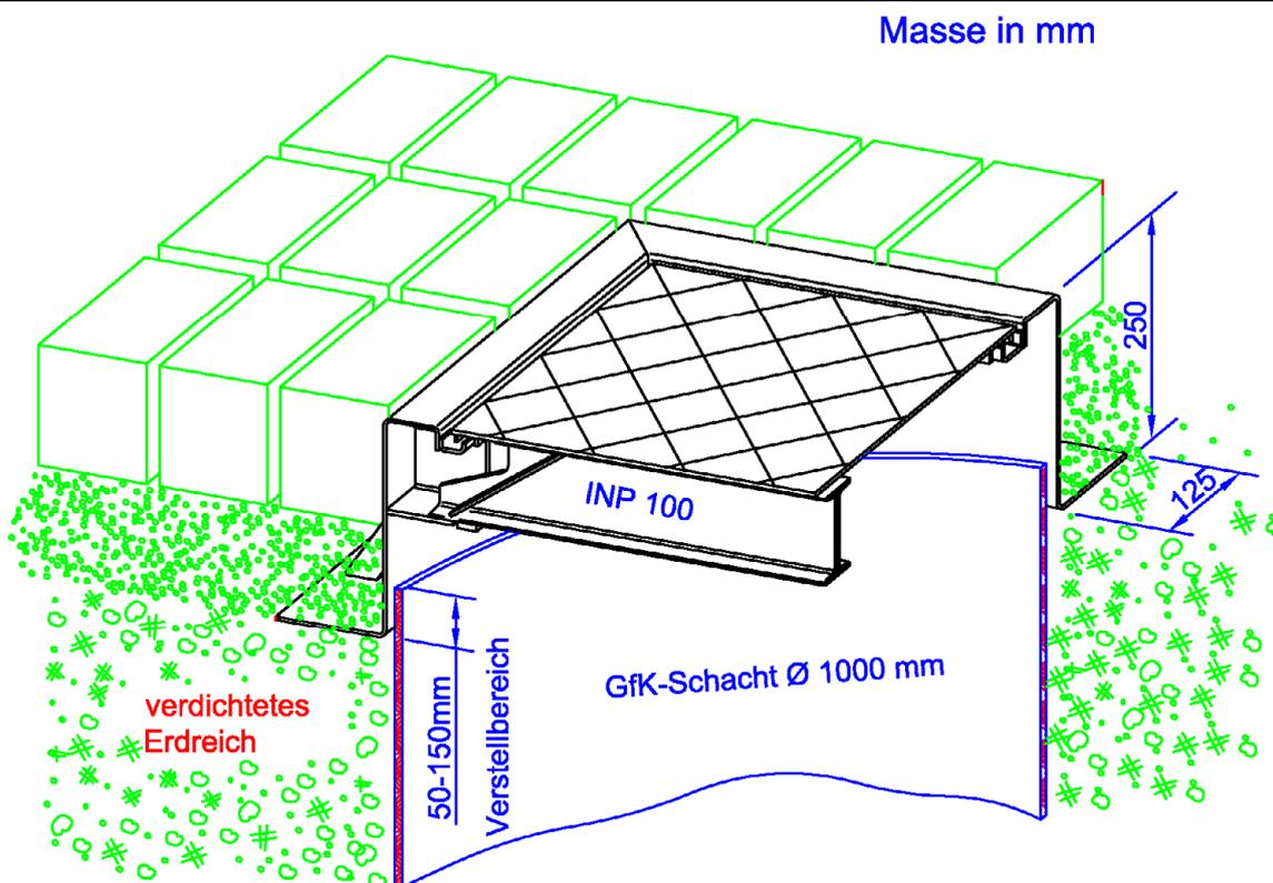
Verlegefertige Abdeckung aus Stahl
