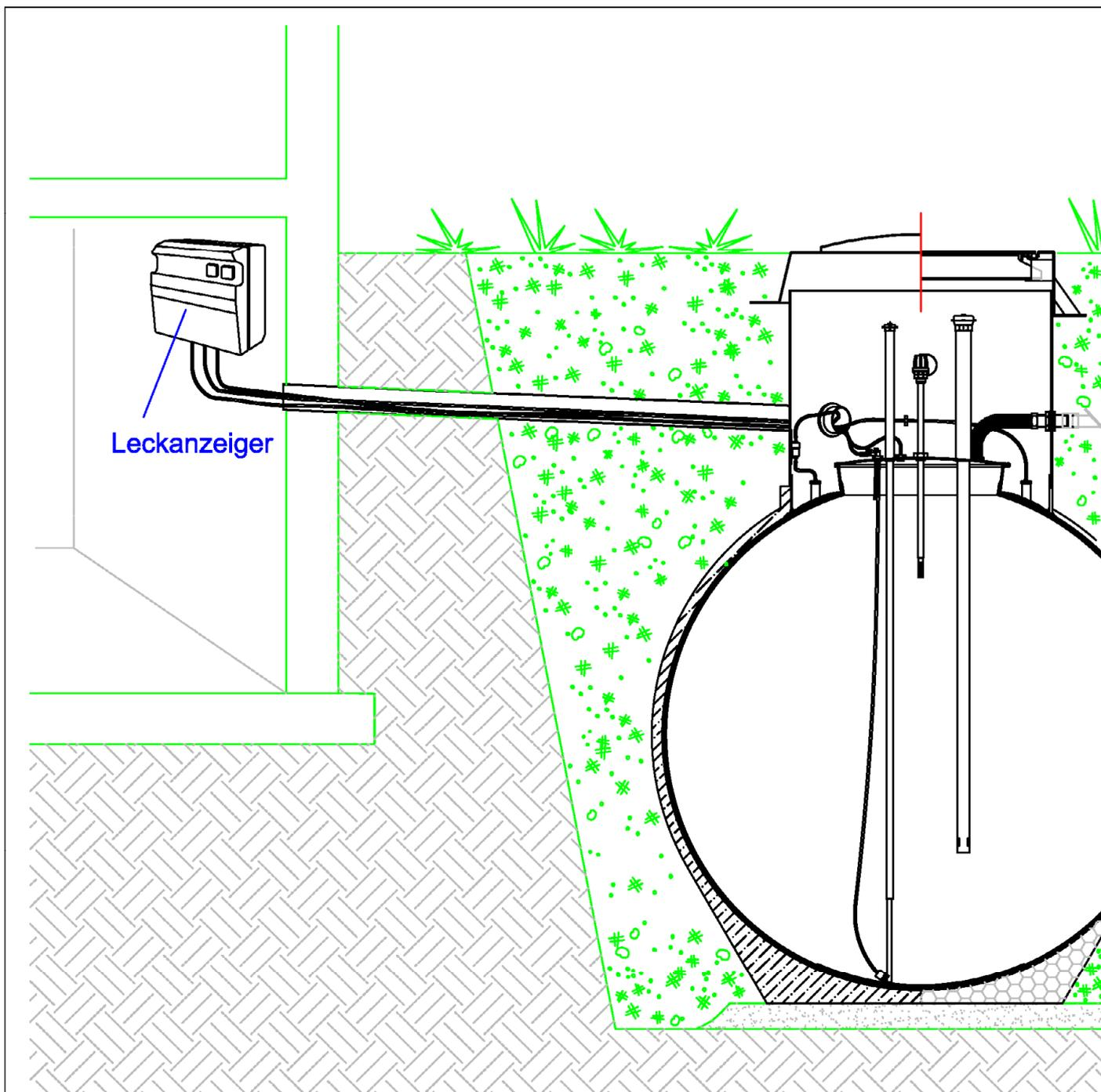
Unterirdische, doppelwandige, kugelförmige Behälter aus GF-UP
