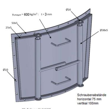
Alle Teile aus Stahl S235 Verbindung mit M8 Bolzen und 3xD Scheiben DIN9021
