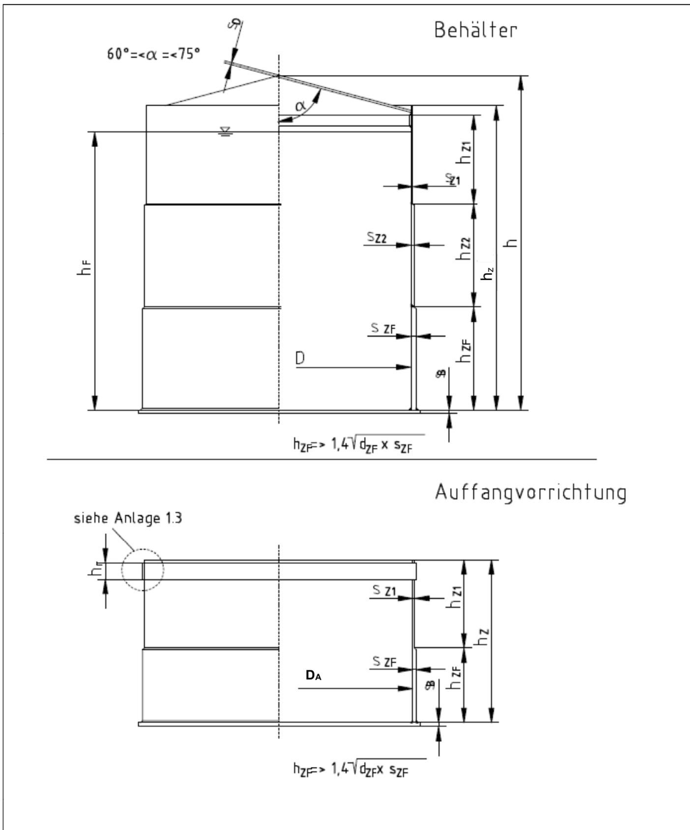
Zylindrische Flachbodenbehälter und Auffangvorrichtung aus Polyethylen (PE 80 und PE 100) mit gewickelten Zylindermänteln (Wickelrohrbehälter)
