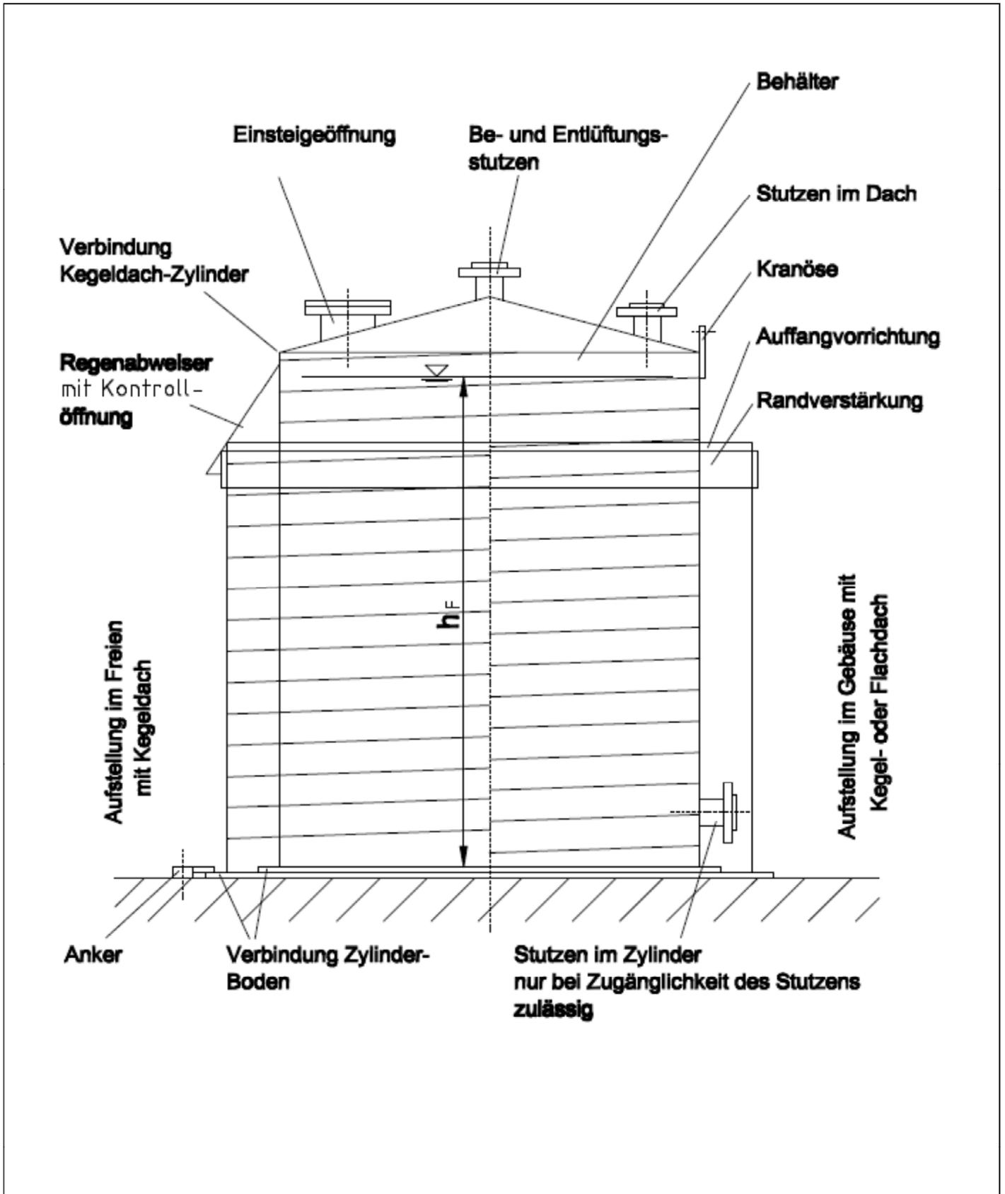
Zylindrische Flachbodenbehälter und Auffangvorrichtung aus Polyethylen (PE 80 und PE 100) mit gewickelten Zylindermänteln (Wickelrohrbehälter)
