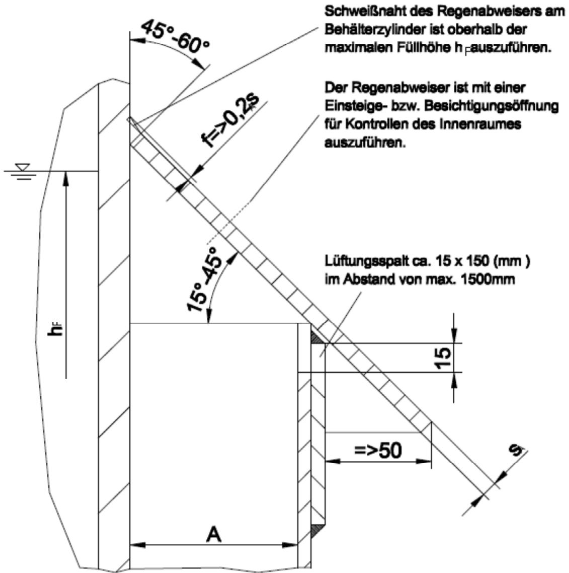
Schweißnaht des Regenabweisers am Behälterzylinder ist oberhalb der maximalen Füllhöhe  $h_F$  auszuführen.
