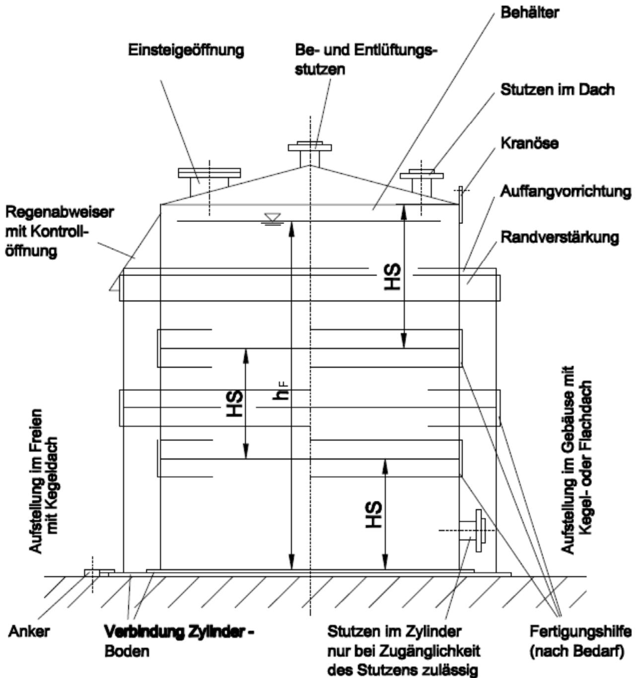
Zylindrische Flachbodenbehälter und Auffangvorrichtung aus Polyethylen (PE 80 und PE 100) mit Zylindermänteln aus verschweißten Tafeln (Tafelbehälter)
