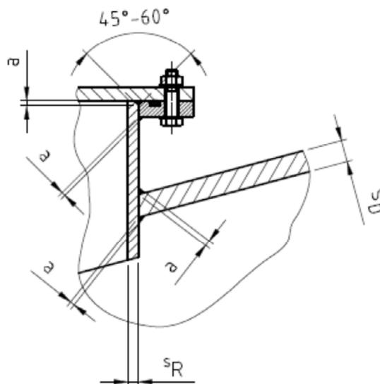
Losedeckel mit Profilspannring
