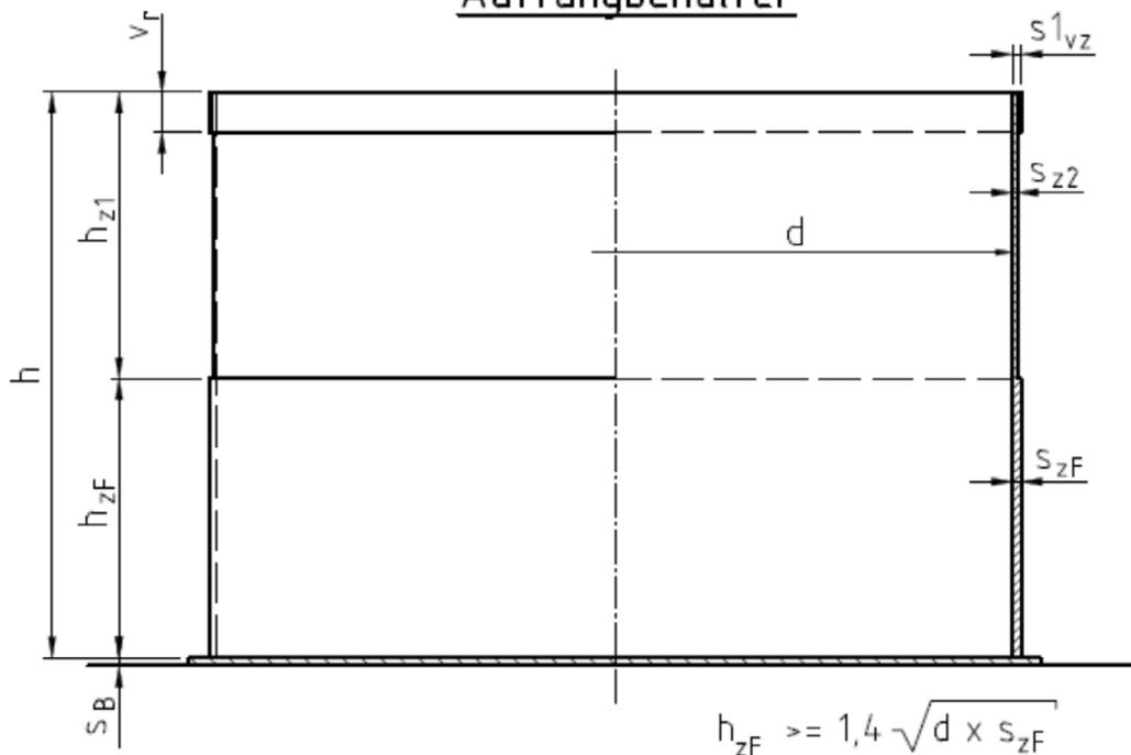
Zylindrische Flachbodenbehälter und Auffangvorrichtungen aus Polyethylen PE 80 und PE 100 mit Zylindermänteln aus verschweißten Tafeln (Tafelbehälter)
