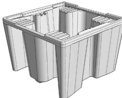
Typ C3 (Doppelstation mit Mittelstütze und Lochplatte, 1000 l)
