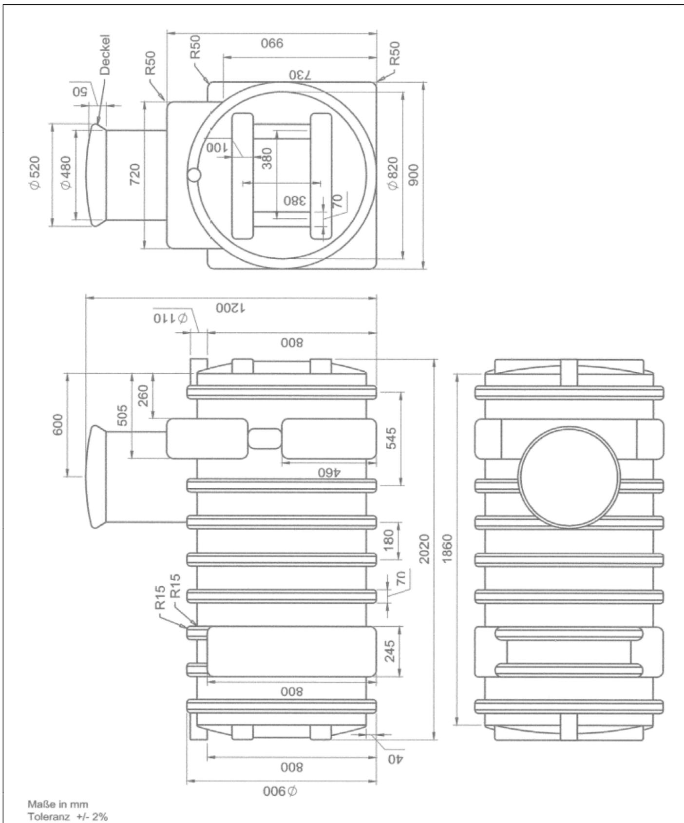
Abflusslose Sammelgruben aus rotationsgeformtem Polyethylen (PE)
