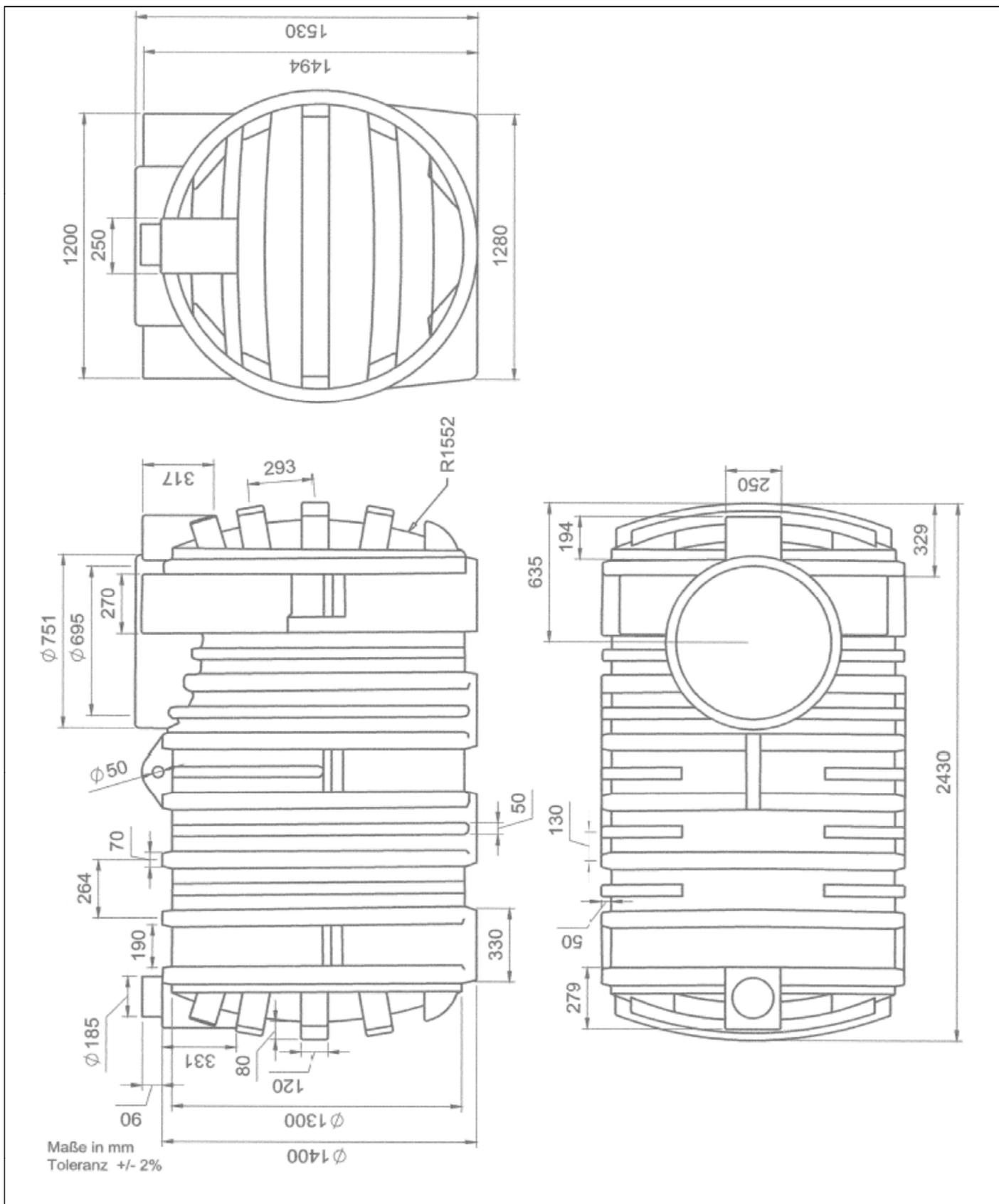
Abflusslose Sammelgruben aus rotationsgeformtem Polyethylen (PE)
