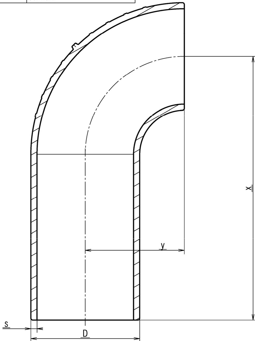
Glattwandige Abwasserrohre und Formstücke mit profilierter Wandung und glatter Innenfläche aus mineralverstärktem PE-HD DN 56 bis DN 150 der Baustoffklasse B2 -normalentflammbar - nach DIN 4102 für Hausabflussleitungen
