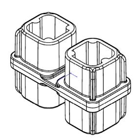
Versickerungsblöcke für die Versickerung von Niederschlägen mit der Bezeichnung "Rigofill inspect"
