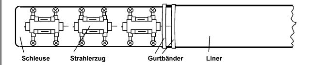
Als Schleuse kann ein Rohr oder Schlauch dienen, der mit dem Liner verbunden wird. Damit kann der Strahlerzug in den mit Druckluft aufgestellten Liner eingezogen werden.
