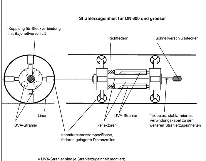
4 UVA-Strahler sind je Strahlerzugeinheit montiert; bis zu 3 Einheiten können zu einem Starhlerzug zusammengesteckt werden
