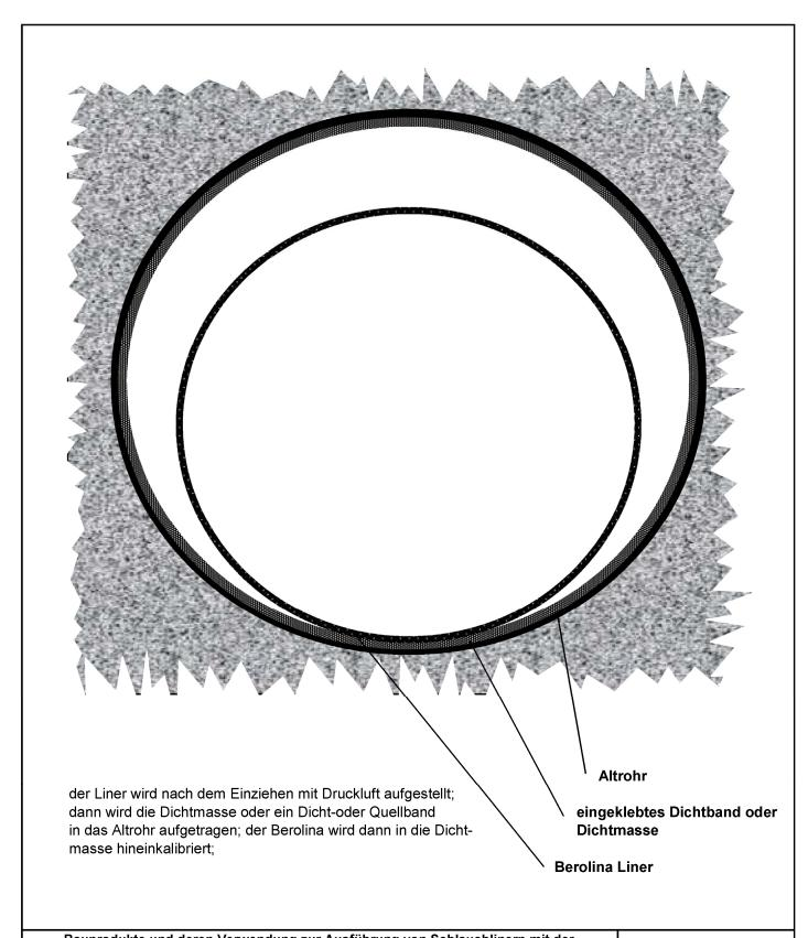
Bauprodukte und deren Verwendung zur Ausführung von Schlauchlinern mit der Bezeichnung "Berolina - Liner" und Berolina - HF - Liner"zur Sanierung von erdverlegten schadhaften Abwasserleitungen mit Kreisprofilen in den Nennweiten DN 150 bis DN 1600 und Eiprofilen in den Nennweiten 200/300 mm bis 1200/1800 mm
