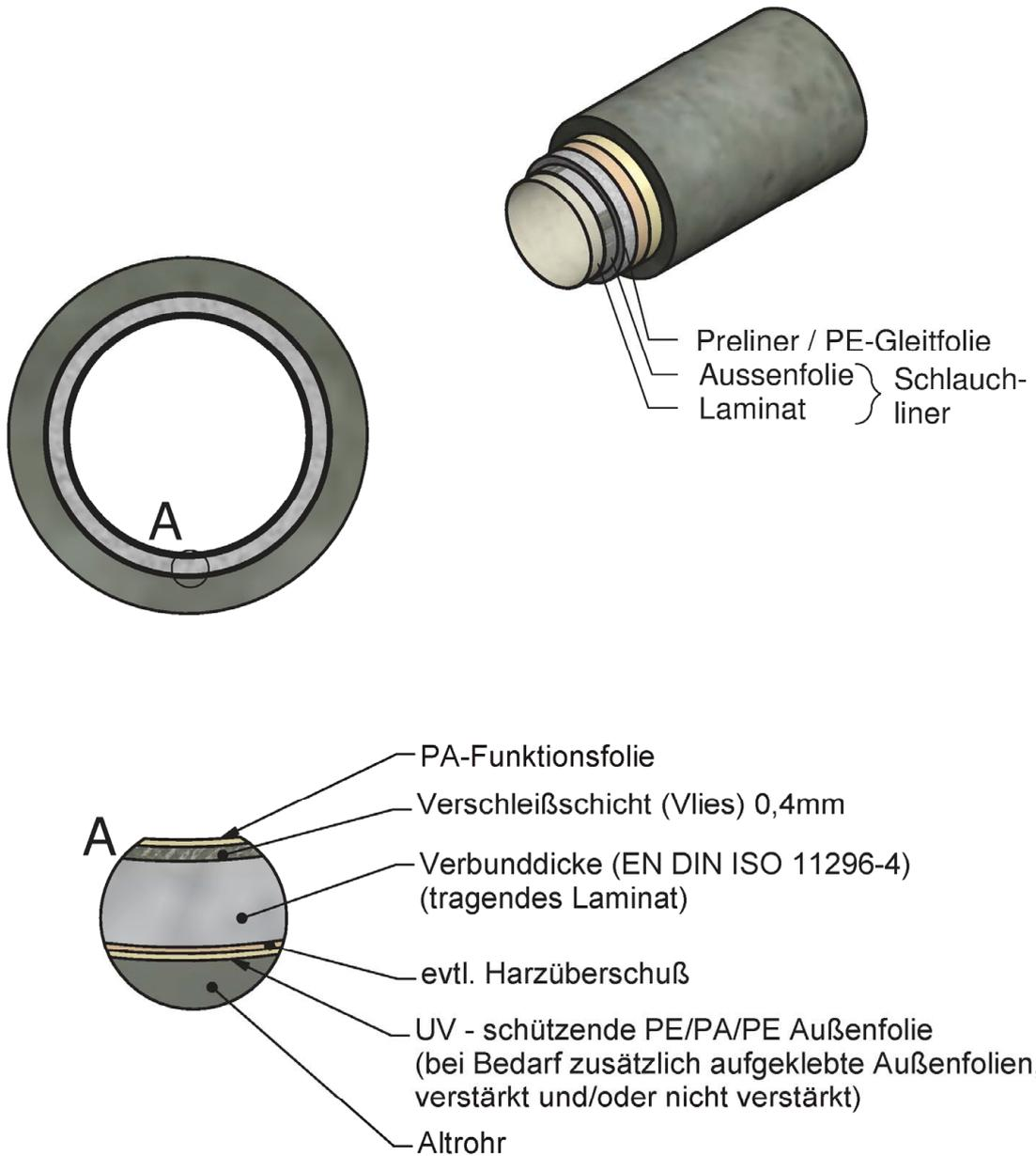
Bauprodukte und deren Verwendung zur Ausführung von Schlauchlinern zur Sanierung schadhafter erdverlegter Abwasserkanäle und-leitungen mit Ei- und Kreisprofilen mit den Bezeichnungen PAA-G-Liner, PAA-G+-Liner und PAA-GL-Liner im Nennweitenbereich von DN 150 bis DN 1200, PAA-EG-Liner im Nennweitenbereich von DN 150 bis DN 600 und PAA-G3-Liner im Nennweitenbereich DN 100 bis 300
