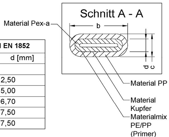
Abdichtung für Abwasserrohre der Nennweite DN/OD 110 bis DN/OD 500 aus Polypropylen mit der Bezeichnung "SABUG IP-plus Schweißsystem"
