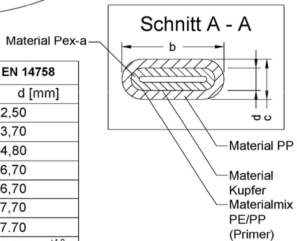
Abdichtung für Abwasserrohre der Nennweite DN/OD 110 bis DN/OD 500 aus Polypropylen mit der Bezeichnung "IP-plus Schweißsystem"
