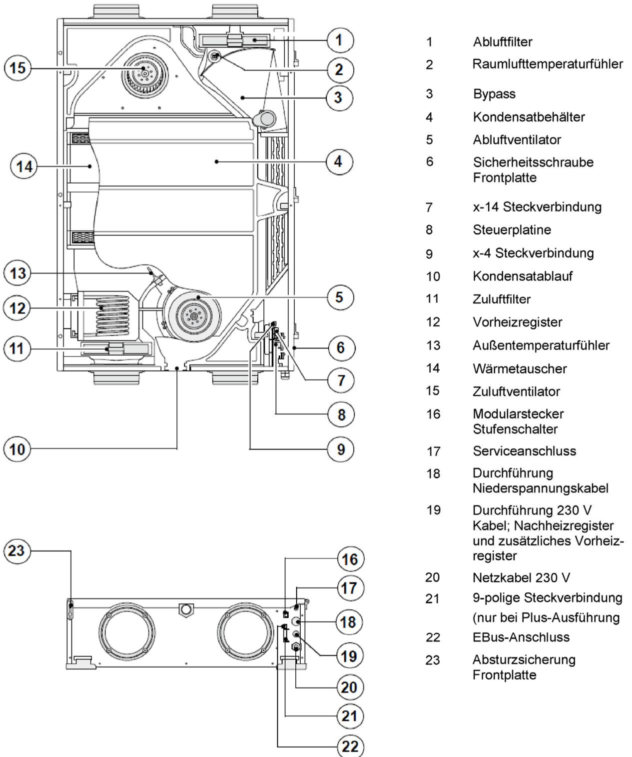
Zentrales Lüftungsgerät mit Wärmerückgewinnung vom Typ "Renovent Sky 150 +"
