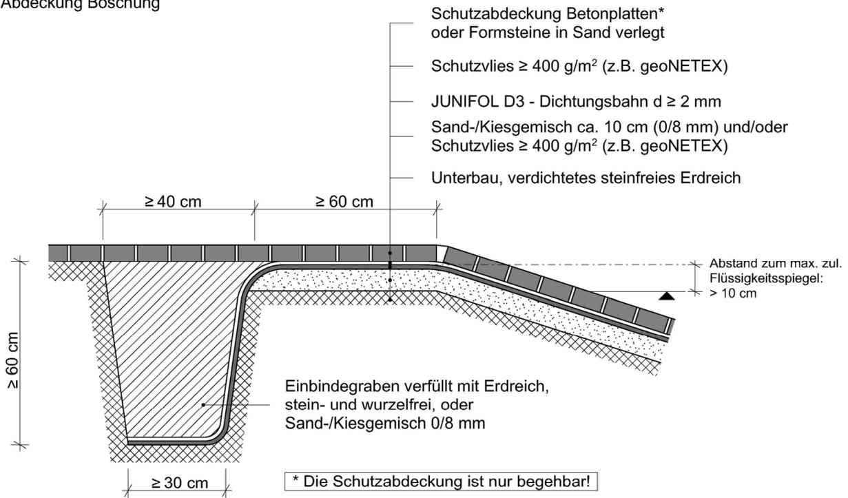
Anschluss am Böschungsfuß
