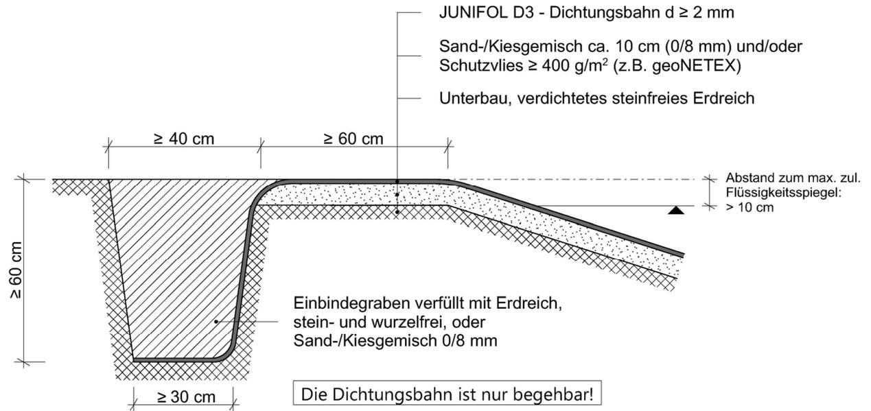
Anschluss am Böschungsfuß
