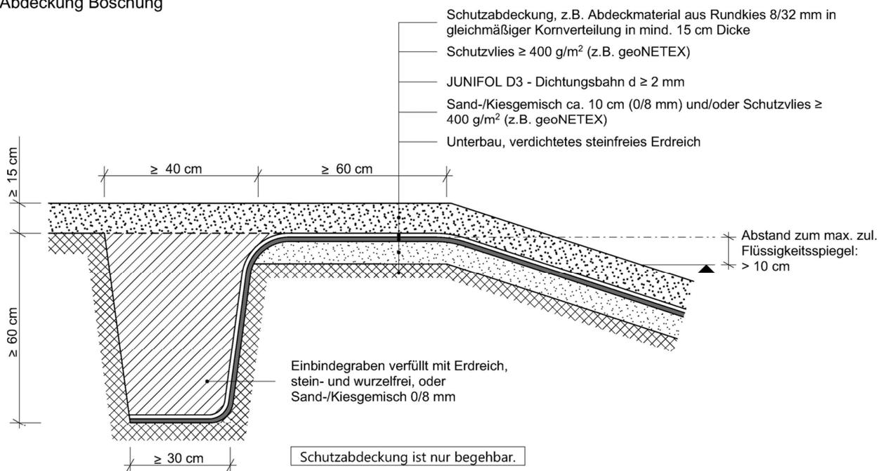
Anschluss am Böschungsfuß
