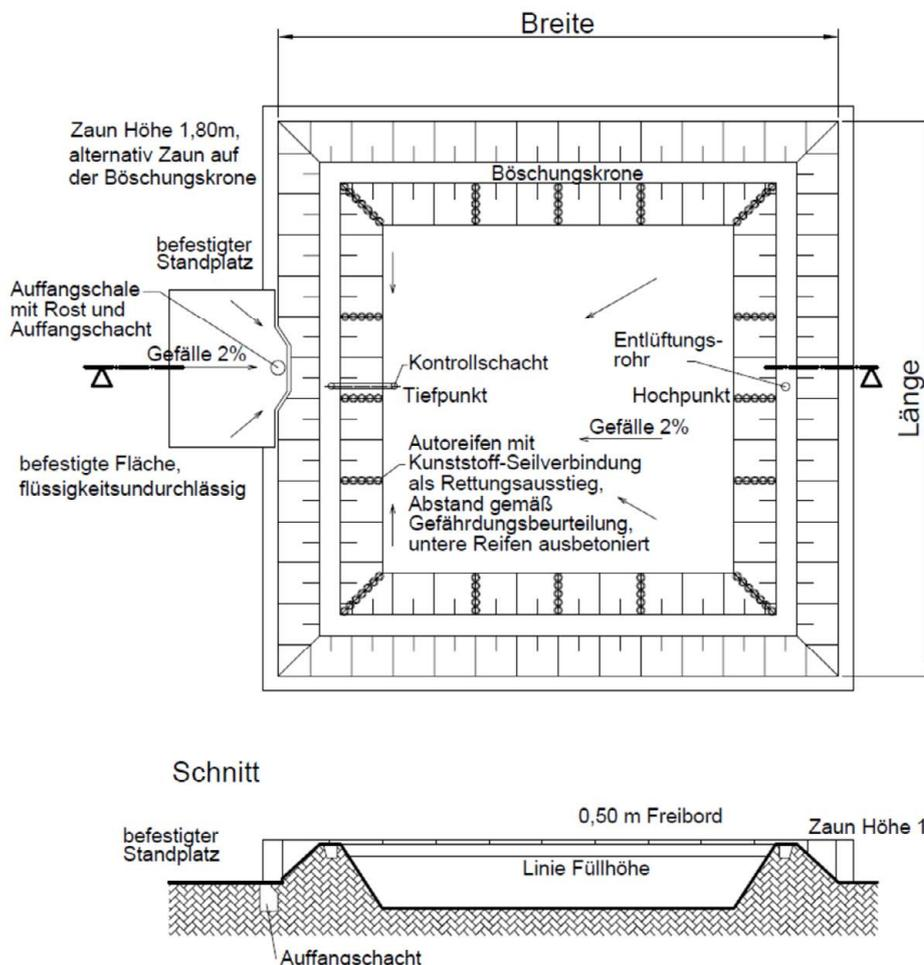
Beckenaufbau (Sohle und innere Böschung)
