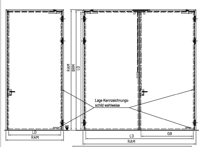
dargestellt: Gangflügel DIN rechts Gangflügel DIN links spiegelbildlich T 90-1-RS-FSA und T 90-2-RS-FSA "SCHWARZE-S1-G" immer mit unterer Bodendichtung oder umlaufender Zargendichtung ausführen und Wandanschluss nach Montageanleitung versiegeln!
