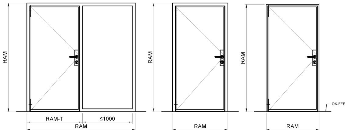
Tür mit Holzblockzarge oder Rohrrahmenzarge und Seitenteil / Oberteil
