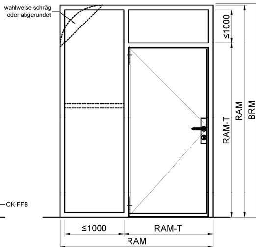
Tür mit Holzblockzarge oder Rohrrahmenzarge und Seitenteil(en)
