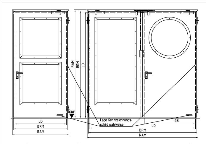
dargestellt: Gangflügel DIN rechts Gangflügel DIN links spiegelbildlich T 30-1-RS-FSA und T 30-2-RS-FSA "SCHWARZE-S20" immer mit unterer Dichtung ausführen und an Wandanschluss immer versiegeln!
