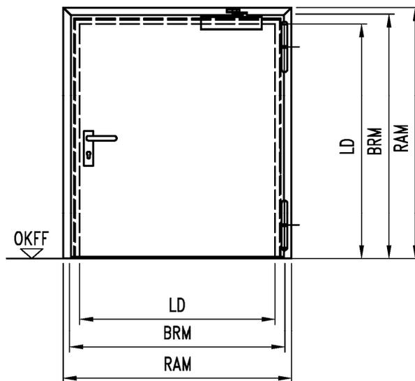
T90-1-RS-FSA immer mit absenkbarer Bodendichtung oder umlaufender Flügeldichtung ausführen und bei Wandanschluss mind. einseitig versiegeln.
