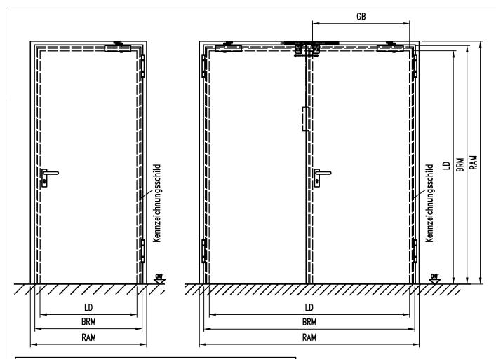
T30-1-RS-FSA und T30-2-RS-FSA immer mit absenkbarer Bodendichtung oder umlaufender Flügeldichtung ausführen. Wandanschluss immer mind. auf Öffnungsseite (Bandseite) des FSA versiegeln !
