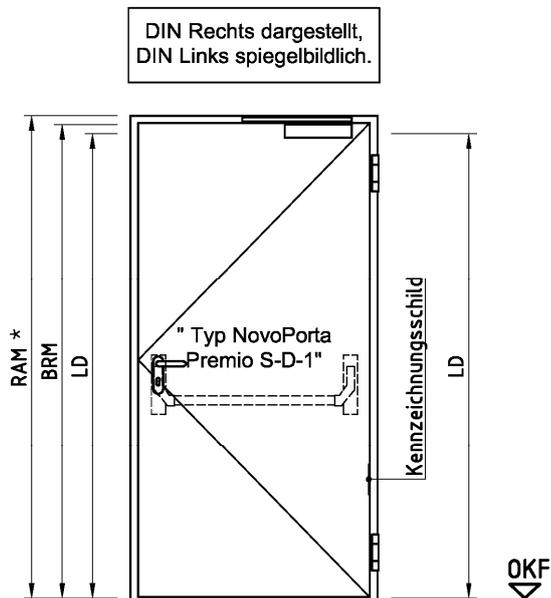
T 30-1-RS-FSA "Typ NovoPorta Premio S-D-1" und immer mit zusätzlicher unterer Bodendichtung oder 4-seitige Dichtung ausführen. Bei Wandanschluss mit Mörtel hinterfüllen ohne Versiegelung, ansonsten mindestens einseitig dauerelastisch versiegeln!
