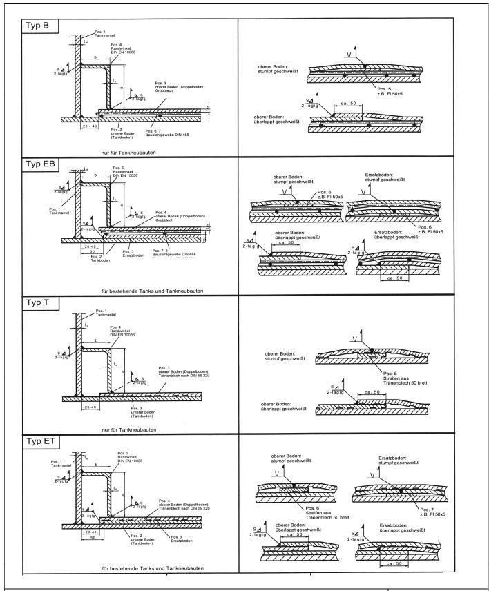
Leckschutzauskleidung aus Stahl der Typen "DoBuRa-T", "DoBuRa-ET", "DoBuRa-B" und
