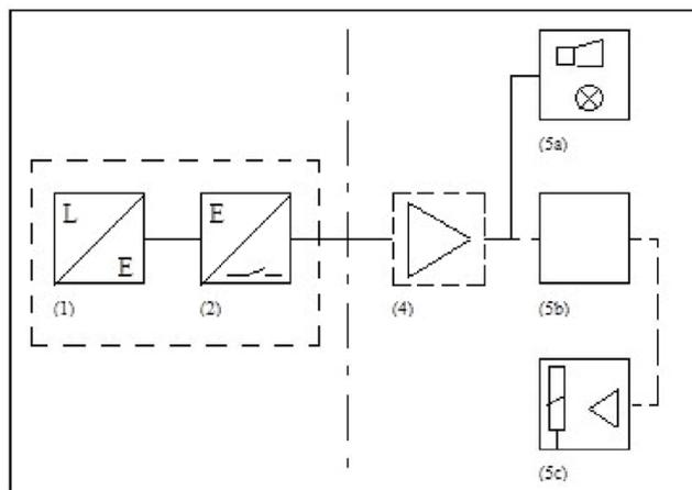
Leckagesonden (konduktive Elektroden) Typ "EP", Typ "ELH" und Typ "EF2" sowie Messumformer als Bauteile von Leckageerkennungssystemen
