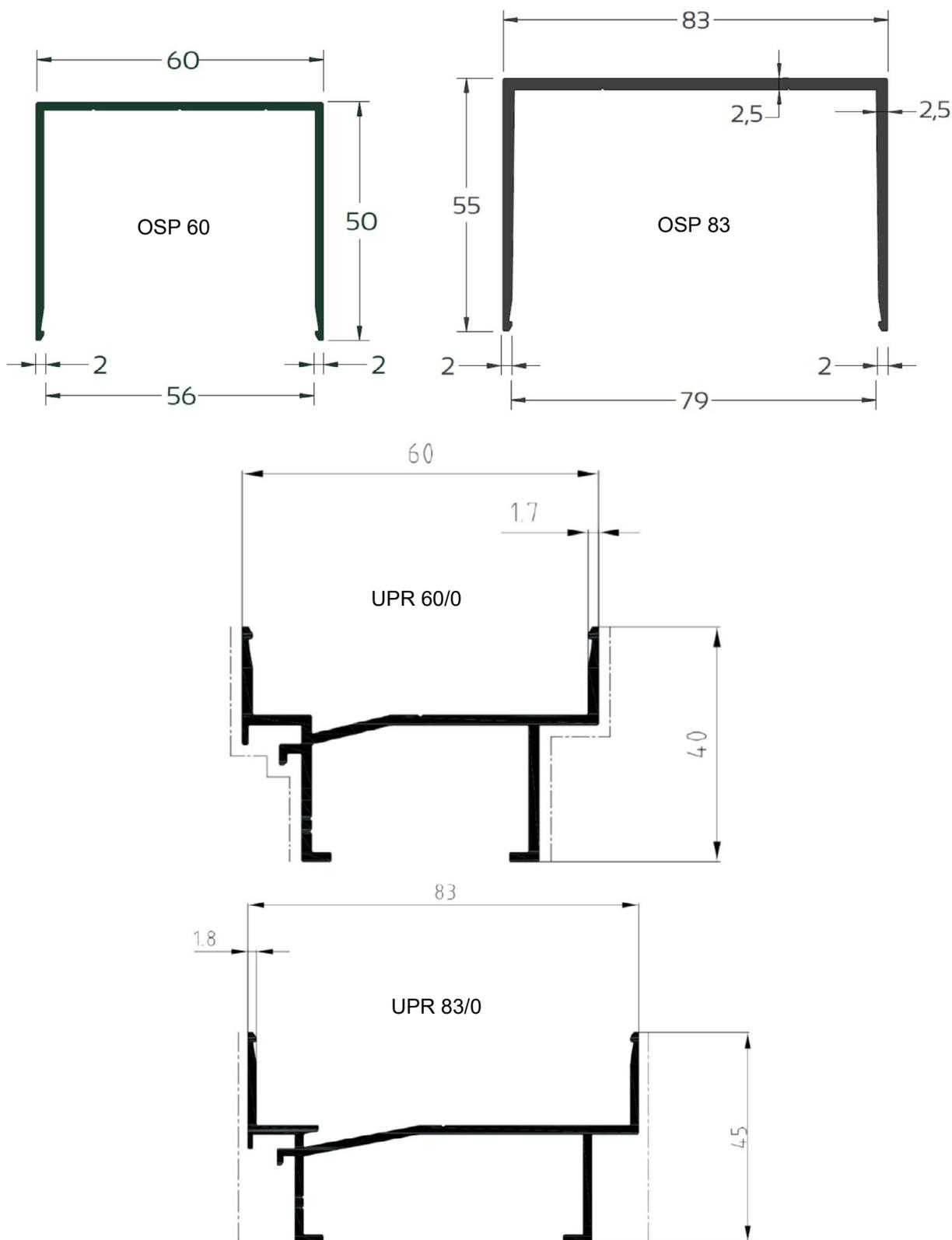
Alle Abmessungen in Millimeter.
