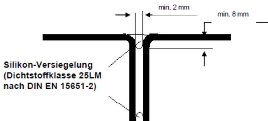
Vertikalverglasungen aus nicht heißgelagertem, thermisch vorgespanntem Profilbauglas "LINIT T"
