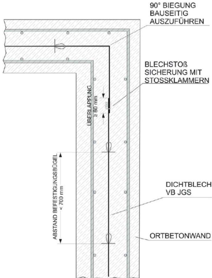
Verbindung der Fugenblechsysteme durch Überlappung und Klemmung, Überlappungsweite: min. 60 mm
