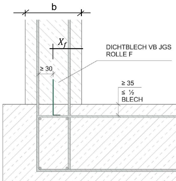
Bild 2: Randbedingungen für den Einbau des Fugenblechsystems (Rollenware mit Montagefuß, siehe Anlage 2)
