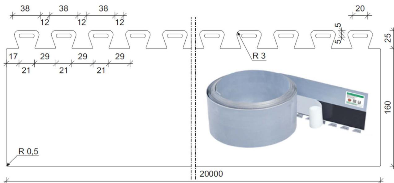
Bild 1: Abmessungen Dichtblech 160 VB JGS Rolle-F
