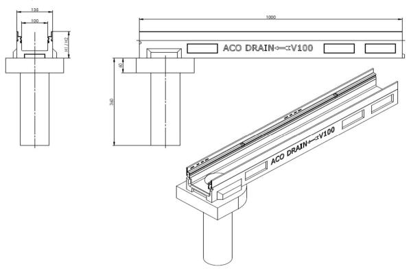
ACO DRAIN Multiline Rinnensystem für die Verwendung in LAU-Anlagen
