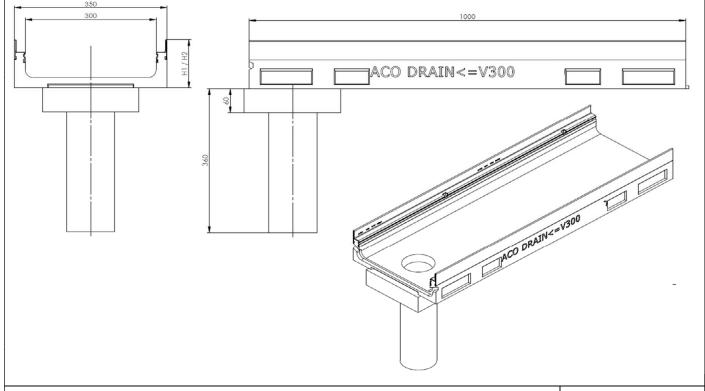
ACO DRAIN Multiline Rinnensystem für die Verwendung in LAU-Anlagen
