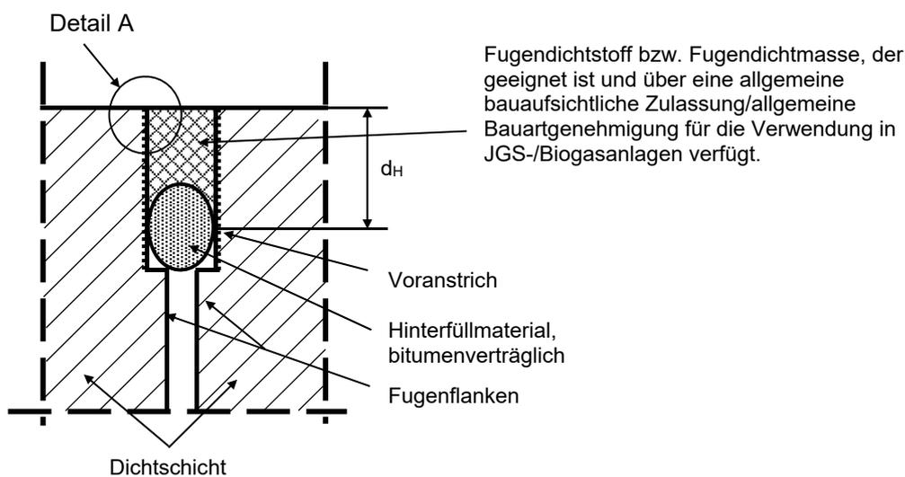
**d<sub>H</sub>** = Haft- bzw. Kontaktfläche des Fugendichtstoffes an der Fugenflanke. Dabei ist zu gewährleisten, dass die Fugenflanken parallel zueinander ausgeführt sind.
