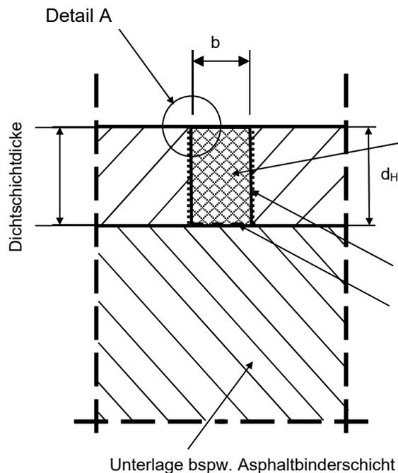
Fugendichtstoff bzw. Fugendichtmasse, der geeignet ist und über eine allgemeine bauaufsichtliche Zulassung/allgemeine Bauartgenehmigung für die Verwendung in JGS-/Biogasanlagen verfügt.
