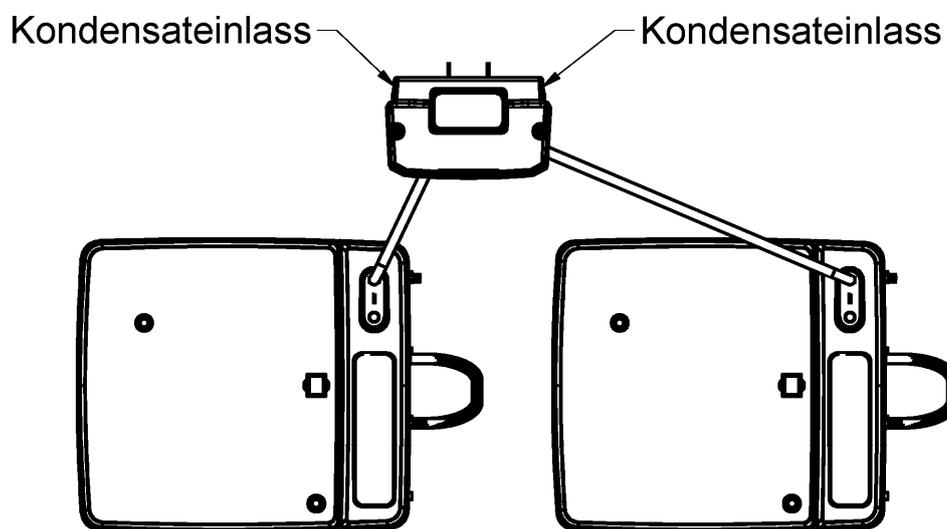
Anlage zur Behandlung von Kompressorenkondensat
