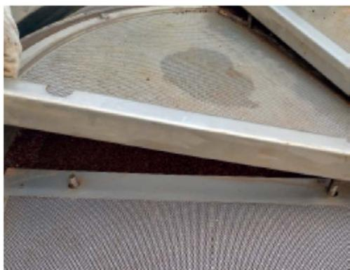
Abb. 6: Siebabdeckung auflegen (Flächen müssen substratfrei sein)
