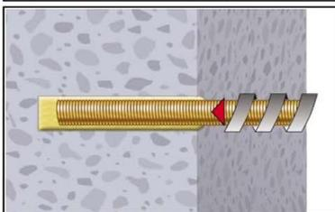
9. Ankerstange mit leichter Drehbewegung bis zur Markierung einführen.
