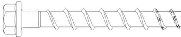
z.B. TOGE Betonschraube zinklamellenbeschichtet, Ausführung mit Sechskantkopf und Anbauteil
