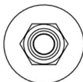
11. Ausführung mit Innengewinde und Sechskantantrieb z.B. TSM 6x55 IM M8/10
