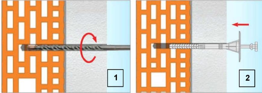
1) Bohrloch senkrecht zur Oberfläche erstellen. Reinigung des Bohrlochs.
