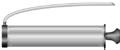
Ausblaspumpe (Volumen 750ml) Bohrerdurchmesser (d 0 ): 10 mm bis 20 mm Verankerungstiefe (h ef ): ≤ 10 d nom für ungerissenen Beton
