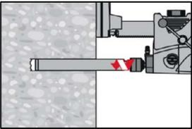
Diamantbohren ist zulässig, wenn geeignete Diamantbohrmaschinen und zugehörige Bohrkronen verwendet werden. Kennwerte zur Verwendung in Kombination mit dem Hilti Aufrauwerkzeug TE-YRT siehe Tabelle B8.
