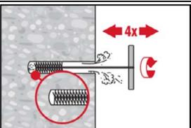
4-mal mit Stahlbürste in passender Größe (siehe Tabelle B7) bürsten. Stahlbürste Hilti HIT-RB mit einer Drehbewegung in das Bohrloch bis zum Bohrlochgrund einführen und wieder herausziehen (falls notwendig mit Verlängerung). Die Bürste muss beim Einführen einen Widerstand erzeugen (Bürsten  $\varnothing \geq$  Bohrloch  $\varnothing$ ) - falls nicht, ist die Bürste zu klein und muss durch eine größere Bürste ersetzt werden.
