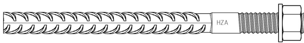
**Hilti Zuganker: HZA M12 bis M27 und HZA-R M12 bis M24**
