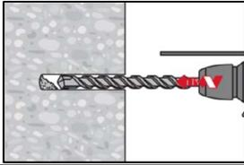
Bohrloch mit Bohrhammer drehschlagend, unter Verwendung des passenden Bohrerdurchmessers auf die richtige Bohrtiefe erstellen.
