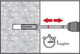
Vor dem Aufrauen muss das Wasser aus dem Bohrloch entfernt werden. Verwendbarkeit des Aufrauwerkzeugs mit der Abnutzungslehre RTG prüfen. Das Bohrloch über die gesamte Bohrtiefe bis zur geforderten Verankerungstiefe  $h_{ef}$  aufrauen. Aufrauzeit  $t_{roughen}$  siehe Tabelle B9.
