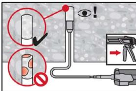
Überkopfanwendung und/oder Montage bei Verankerungstiefen von  $h_{ef} > 250\text{mm}$ .
