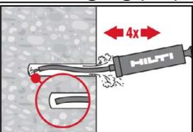
Für Bohrdurchmesser  $d_0 \leq 20$  mm und Bohrlochtiefen  $h_0 \leq 10 \cdot d$ . Das Bohrloch mindestens 4-mal mit der Hilti Ausblaspumpe vom Bohrlochgrund ausblasen, bis die rückströmende Luft staubfrei ist.
