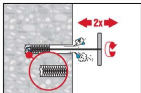
2-mal mit Stahlbürste in passender Größe (siehe Tabelle B7) bürsten. Stahlbürste Hilti HIT-RB mit einer Drehbewegung in das Bohrloch bis zum Bohrlochgrund einführen und wieder herausziehen (falls notwendig mit Verlängerung). Die Bürste muss beim Einführen einen Widerstand erzeugen (Bürsten  $\varnothing \geq$  Bohrloch  $\varnothing$ ) - falls nicht, ist die Bürste zu klein und muss durch eine größere Bürste ersetzt werden.
