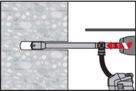
Die Bohrlocherstellung bis zur erforderlichen Setztiefe erfolgt drehschlagend mit einem Hilti Hohlbohrer TE-CD oder TE-YD mit angeschlossenem Staubsauger gemäß den Anforderungen nach Tabelle B7. Dieses Bohrsystem beseitigt bei Anwendung gemäß der Gebrauchsanweisung des Hohlbohrers das Bohrmehl und reinigt das Bohrloch während des Bohrvorgangs. Nach Beendigung des Bohrens kann mit der Mörtelverfüllung gemäß Montageanweisung begonnen werden.
