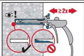
Bohrloch 2-mal vom Bohrlochgrund über die gesamte Länge mit ölfreier Druckluft (min. 6 bar bei 6 m<sup>3</sup>/h; falls notwendig mit Verlängerung) ausblasen, bis die rückströmende Luft staubfrei und das Bohrloch trocken ist. Vor dem Verfüllen mit Mörtel das Wasser vollständig aus dem Bohrloch entfernen bis das Bohrloch vollständig trocken ist ( $t_{blowing}$  siehe Tabelle B9). Für Bohrlochdurchmesser  $\geq 32$  mm muss der Kompressor mindestens 140 m<sup>3</sup>/h Luftstrom haben.
