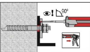
Ringspalt zwischen Ankerstange und Anbauteil mit Hilti Injektionsmörtel HIT-HY 200 oder HIT-HY 200 V3 vollständig verfüllen. Der Statikmischer muss rechtwinklig auf der Verfüllöffnung aufgesetzt sein. Befolgen der Setzanweisung der dem Mörtel HIT-HY 200 oder HIT-HY 200 V3 beigelegten Gebrauchsanweisung. Nach Ablauf der erforderlichen Aushärtezeit  $t_{cure}$  (siehe Tabelle B4) kann das Befestigungselement belastet werden.
