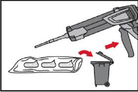
Das Öffnen der Foliengebinde erfolgt automatisch bei Auspressbeginn. Der am Anfang aus dem Mischer austretende Mörtelvorlauf darf nicht für Befestigungen verwendet werden. Die Menge des Mörtelvorlaufes ist abhängig von der Gebindegröße:
