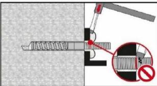
Beim Entfernen des überstehenden Mörtels das Gewinde der HIT-Z(-R)-D TP Ankerstange nicht beschädigen.
