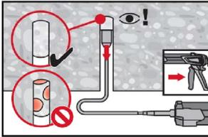
Das Injizieren des Mörtels bei Überkopfanwendung ist nur mit Hilfe von Stauzapfen und Verlängerungen möglich. HIT-RE-M Mischer, Mischerverlängerung und entsprechenden Stauzapfen Hilti HIT-SZ18 zusammenfügen. Den Stauzapfen bis zum Bohrlochgrund einführen und Mörtel injizieren. Während der Injektion wird der Stauzapfen über den Staudruck vom Bohrlochgrund automatisch nach außen geschoben.
