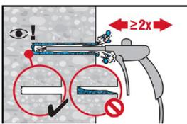
Bohrloch 2-mal mit ölfreier Druckluft (min. 6 bar bei 6m<sup>3</sup>/h; falls notwendig mit Verlängerung) ausblasen, bis die rückströmende Luft staubfrei und frei von Wasser ist.
