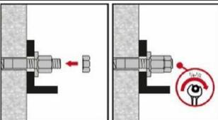
Sicherungsmutter von Hand aufdrehen und mit einer  $\frac{1}{4}$  bis  $\frac{1}{2}$  Drehung anziehen. Anschließend kann das Befestigungselement belastet werden.
