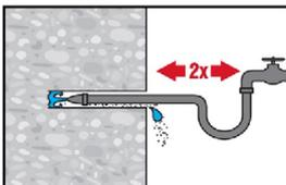
Bohrloch 2-mal mittels Wasser mit einem Schlauch vom Bohrlochgrund spülen, bis klares Wasser aus dem Bohrloch austritt. Normaler Wasserleitungsdruck genügt.
