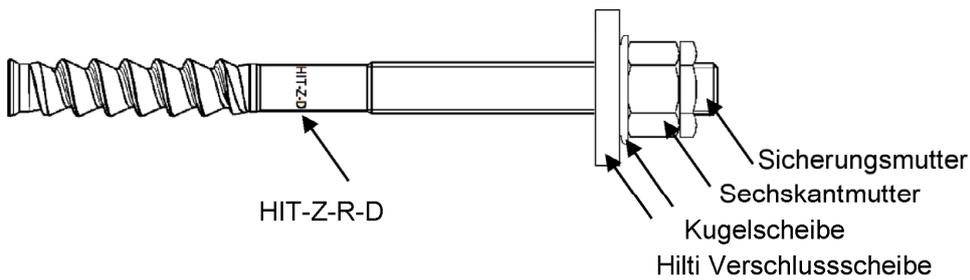
**Hilti Verfüll-Set** zum Verfüllen des Ringspalts zwischen Befestigungselement und Anbauteil
