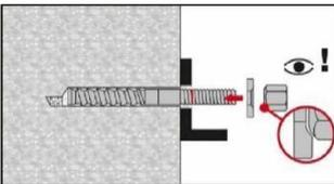
Kugelige Seite der Mutter zur Kegelpfanne orientieren und auf Gewinde montieren.
