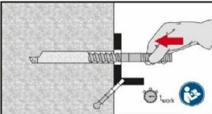
Vor der Montage sicherstellen, dass das Element trocken und frei von Öl und anderen Verunreinigungen ist. Element bis zur gewünschten Verankerungstiefe einführen, noch bevor die Verarbeitungszeit  $t_{work}$  (siehe Tabelle B4) abgelaufen ist.
