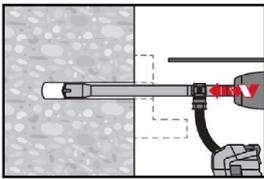
Vorsteck-/ Durchsteckmontage: Die Bohrlocherstellung bis zur erforderlichen Setztiefe erfolgt drehschlagend mit einem Hilti Hohlbohrer TE-CD oder TE-YD mit angeschlossenem Staubsauger gemäß den Anforderungen nach Tabelle B5. Dieses Bohrsystem beseitigt das Bohrmehl und reinigt das Bohrloch während des Bohrvorgangs. (siehe Anhang A1 – Setzbedingung ☺). Nach Erstellen des Bohrlochs kann mit dem Arbeitsschritt „Injektionsvorbereitung“ gemäß Montageanweisung fortgefahren werden.
