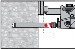
Diamantbohren ist zulässig, wenn geeignete Diamantbohrmaschinen und zugehörige Bohrkronen verwendet werden.
