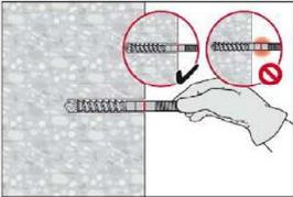
Befestigungselement markieren und Setztiefe kontrollieren. Die Ankerstange muss bis zur Setztiefenmarkierung in das Bohrloch passen.
