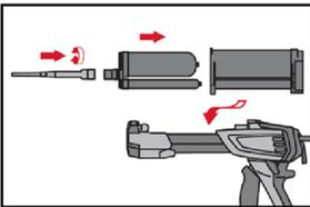
Statkmischer HIT-RE-M fest auf Foliengebinde aufschrauben. Den Mischer unter keinen Umständen verändern. Befolgen Sie die Bedienungsanleitung des Auspressgerätes und des Mörtels.
