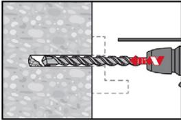
Durchsteckmontage: Bohrloch durch das Durchgangsloch im anzuschließenden Bauteil mit Bohrhämmer drehschlagend, unter Verwendung des passenden Bohrerdurchmessers auf die richtige Bohrtiefe erstellen.
