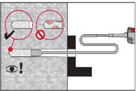
Injizieren des Mörtels mit Hilfe von Stauzapfen und Verlängerungen möglich. HIT-RE-M Mischer, Mischerverlängerung und entsprechenden Stauzapfen Hilti HIT-SZ18 zusammenfügen. Den Stauzapfen bis zum Bohrlochgrund einführen und Mörtel injizieren. Während der Injektion wird der Stauzapfen über den Staudruck vom Bohrlochgrund automatisch nach außen geschoben. Die Mörtelmenge ist so zu wählen, dass der Ringspalt im Bohrloch vollständig gefüllt ist.
