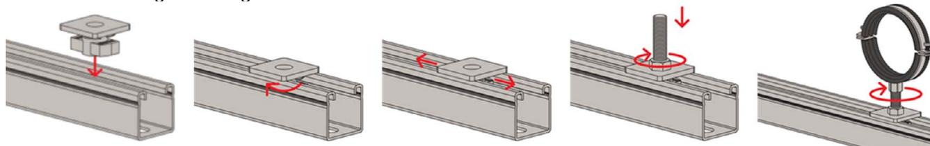
In Tabelle B 2.1 sind die Montagedrehmomente  $T_{inst}$  für die Montage der Schiebemutter FCN Clix M in Kombination mit einer Gewindestange der Festigkeitsklasse 4.8 oder besser mit dem FUS-Schienensystem in Abhängigkeit von der Gewindegröße angegeben.
