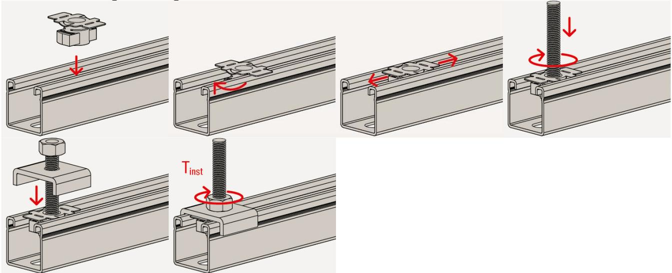
In Tabelle B3.1 sind die Montag Drehmomente  $T_{inst}$  für die Montage der Schiebemutter FCN Clix P in Verbindung mit der Halteklau HK 41 und einer Gewindestange der Festigkeitsklasse 4.8 oder besser mit dem FUS-Schienensystem in Abhängigkeit von der Gewindegröße angegeben.
