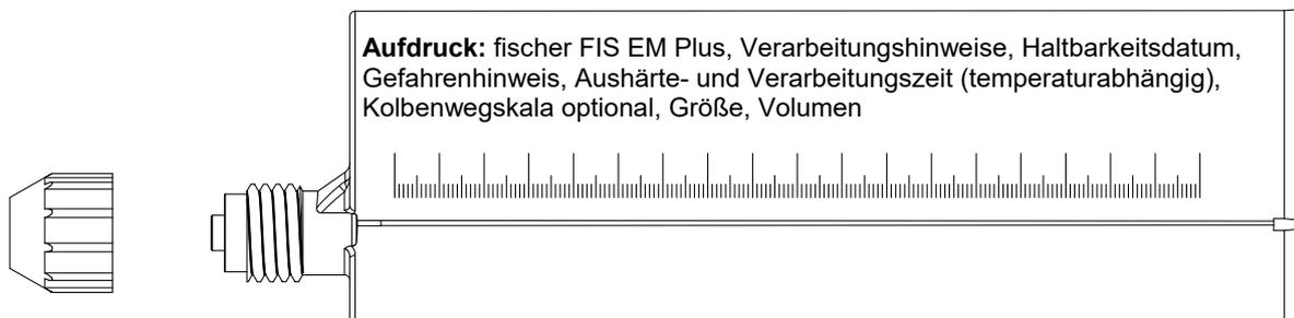
**Statikmischer FIS MR Plus für Injektionskartuschen 390 ml**
